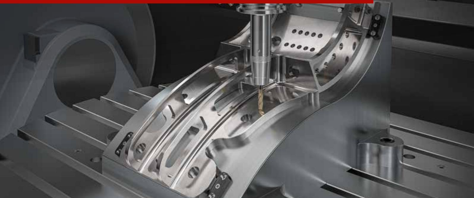
SolidCAM HSS ist ein umfangreiches und leistungsstarkes Modul für die Herstellung hochwertiger Flächen und Hinterschnitte mit Standard- und Formfräsern. Die zu bearbeitenden Flächen des Werkstücks lassen sich einfach am Modell auswählen – ohne Definition von Begrenzungslinien.
